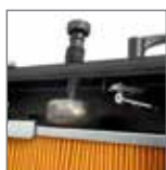
Grote paneelfilter met manuele filterreiniging
